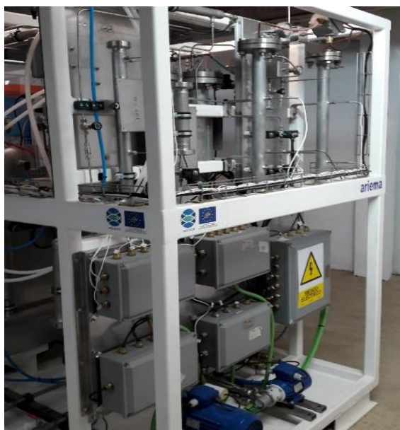
Ilustración 1. Electrolizador para la obtención de oxígeno e hidrógeno (Fte: ARIEMA)
