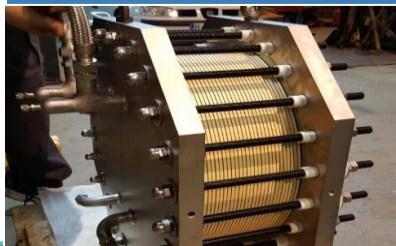
Prototipo de pila de combustible 1,5kW
