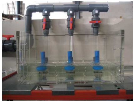
Modelo a escala de estación de bombeo
