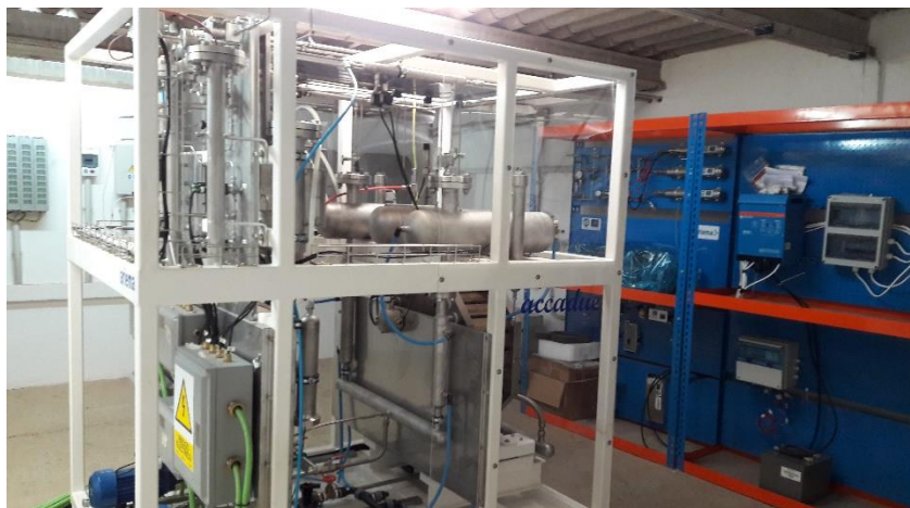
Prototipos de electrolisis y almacenamiento de hidrógeno instalados en Esteros de Canela
