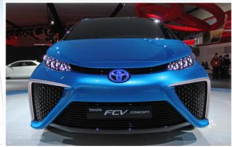
El **Toyota FCV** cuenta con dos **depósitos de hidrógeno** colocados bajo el piso del vehículo. Se trata de dos depósitos a alta presión (**70 Mpa**), que tardan en repostarse en torno a unos tres minutos. La **autonomía** declarada por la marca japonesa es de algo **más de 500 km**.
